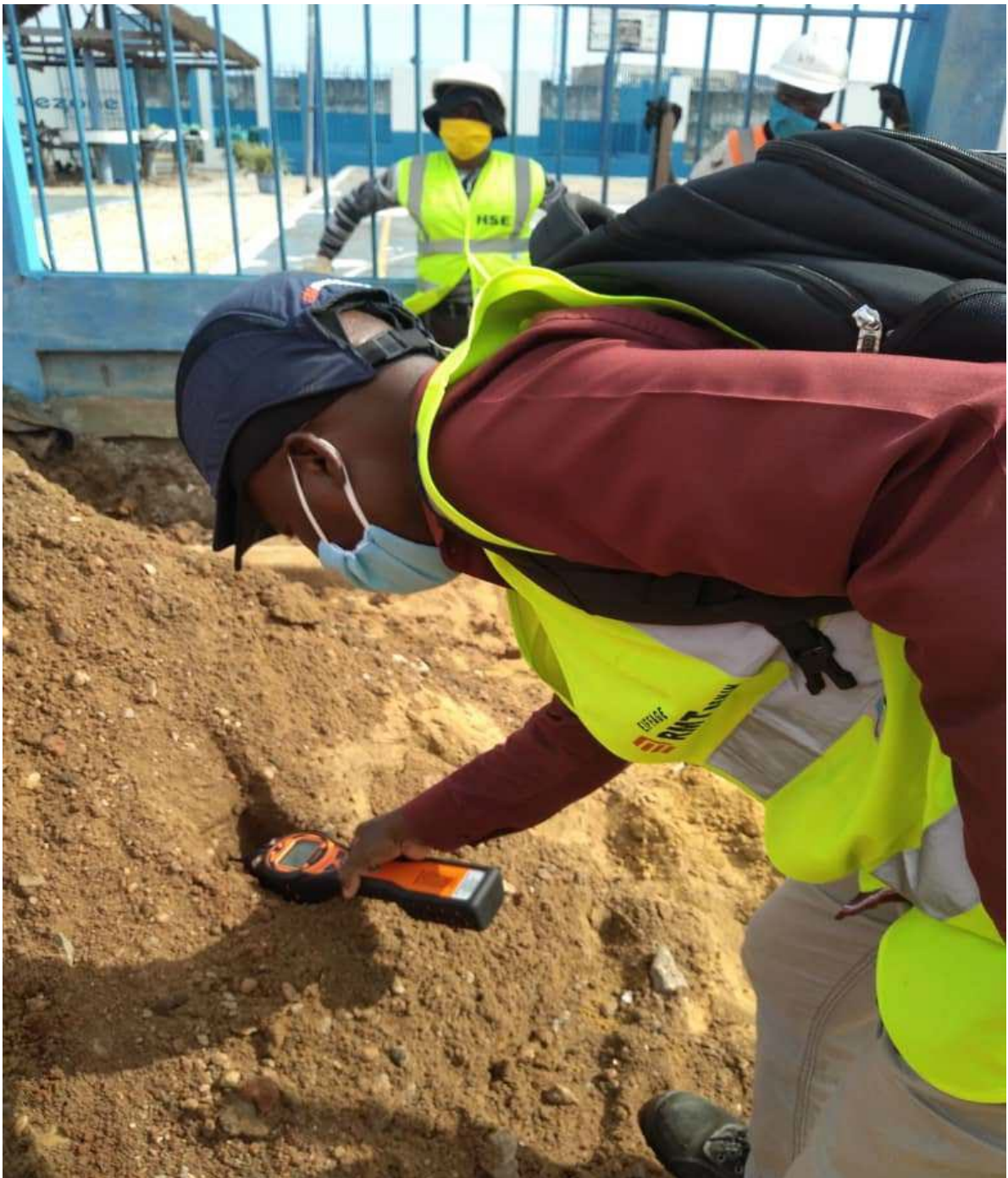
Image 1 : Essai de détection de sols contaminés par le détecteur
