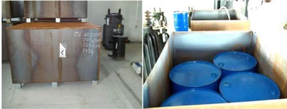
Bacs de rétention métalliques étanches capables de retenir les liquides en cas de fuite lors du transport des transformateurs, condensateurs et des déchets solides.
