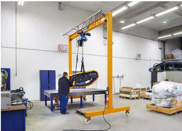
**Figure 3 : exemple de portique sur roues (à titre indicatif seulement, les dimensions ne sont pas représentatives)**
